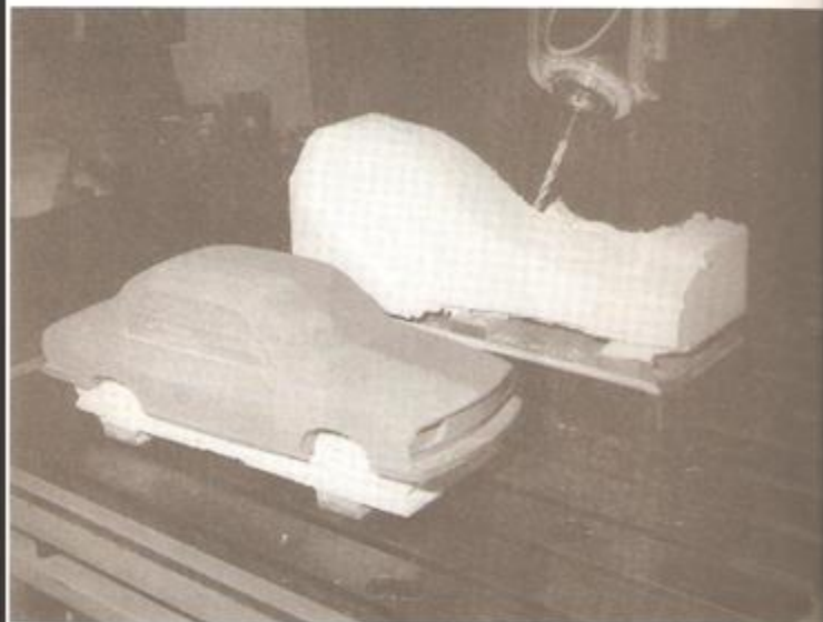
Maquette de voiture (échelle 1/8) et carter d'embrayage (échelle 1/1) en cours d'usinage (Doc. SOFERMO).
